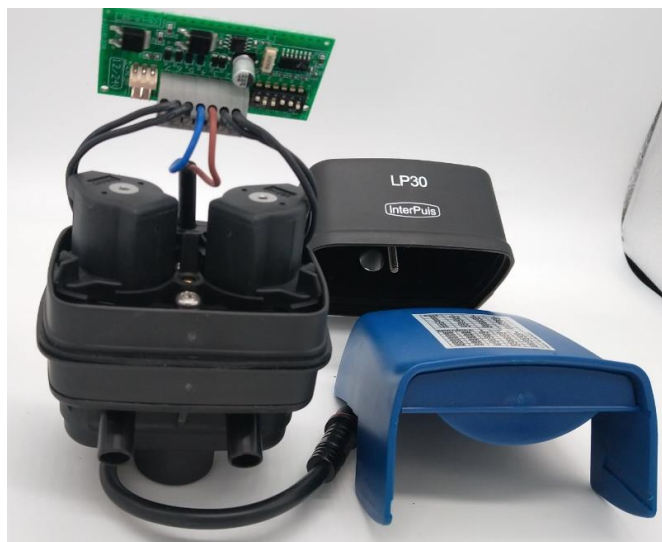
Рис. 1.4. Внутрішня будова пульсатора LE30 із вбудованою платою керування
