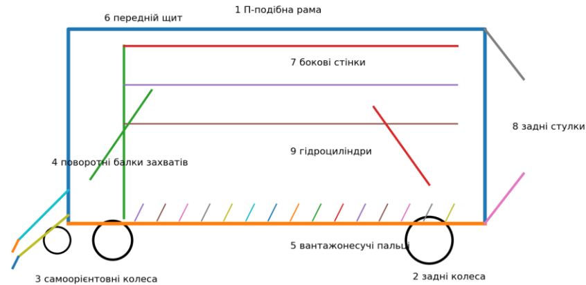
Рис. 3.1. Узагальнена схема самонавантажувального копновозу для транспортування копиць рослинної маси
