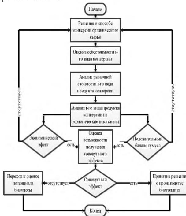
Рис.4. Алгоритм принятия решения о способе производства биотоплива
