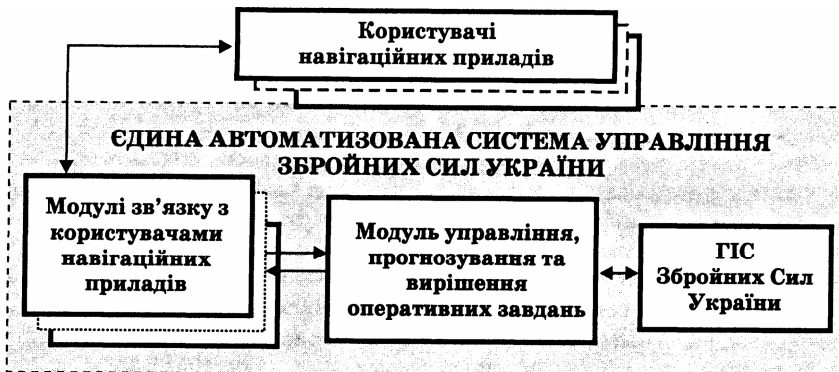
Рис. 1.1. Схема функціонування підсистеми управління користувачами навігаційних засобів ГІС Збройних Сил України.
