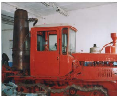
Рис. 3 та 4. Встановлення газогенераторної установки на трактор ДТ-175С.
