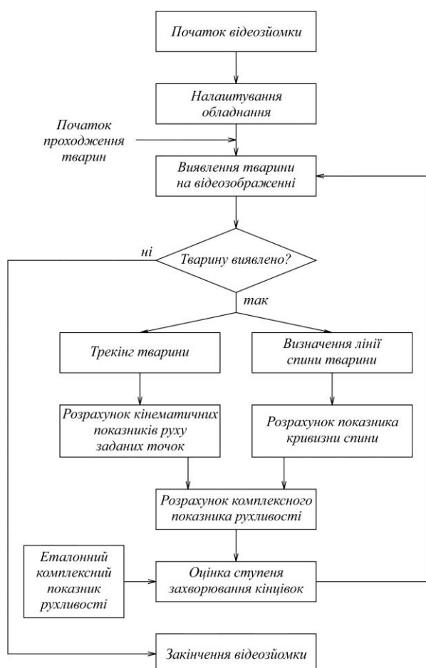
Рис. 2. Блок-схема алгоритму процесу аналізу руху ВРХ для випадку визначення як кінематичних показників руху, так і вигину спини тварини
